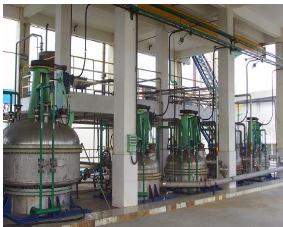
图九 用于苯和甲苯硝化的列管式内环流反应器
