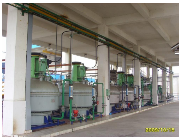
图十二 江苏某公司硝化的连续中和洗涤装置
